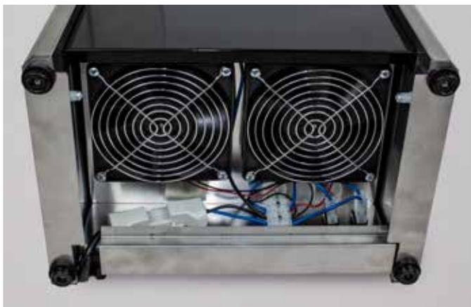
Rengör försiktigt apparatens kondensatorfläktar, till exempel med borstmunstycket på en dammsugare. Håll försiktigt den tomma enheten på dess baksida för att göra det lättare att dammsuga fläktarna. Det rekommenderas att rengöra enheten var 6:e månad.
