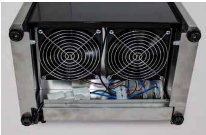
Puhdista laitteen lauhduttimen puhaltimet varovasti esimerkiksi pölynimurin harjasuulakkeella. Kaada tyhjä laite varovasti selälleen, jolloin puhaltimet on helpompi imuroida. Puhdistus on hyvä suorittaa 6 kk välein.
