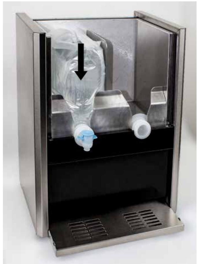
Laske valmiiksi jäähdetty hanapussi varovasti säiliön U-hahloon siten, että hanan suurin kaulus jää alumiinilevyn taakse säiliön sisäpuolelle (C). Hanan uloin kaulus asettuu mustan paneelipellin ulkopuolelle (D).
