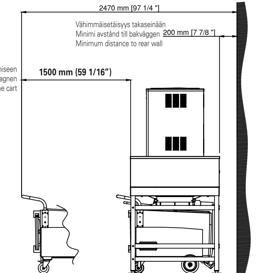
Vedenpoistoliitintä on käänettävä ja voi poistua vasemmalle tai oikealle. Suosittelemme asennusta lattialle, jossa on lattiakaivo. On suositeltavaa, että lattiakaivo sijaitsee laitteen alla. Poistoliitintään sopii Ø 25 - 30 mm putket.
